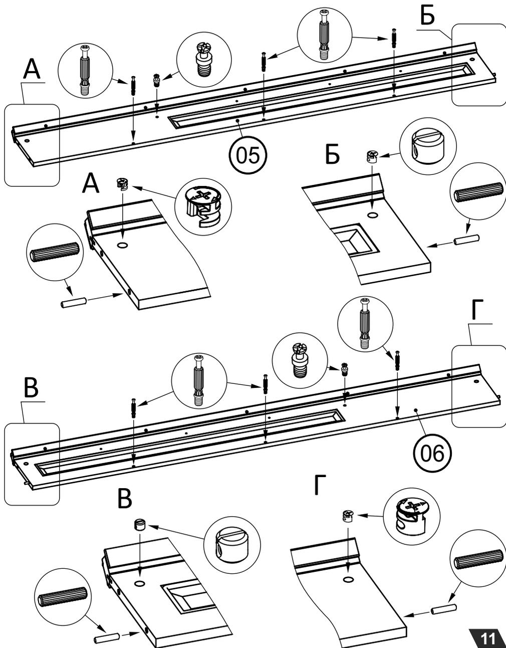
Установить стенку вертикальную левую 05 отверстием в нижней кромке на соединительный винт цоколя 02, при этом шканти стенки вертикальной должен совпасть с соответствующим отверстием цоколя 02.
