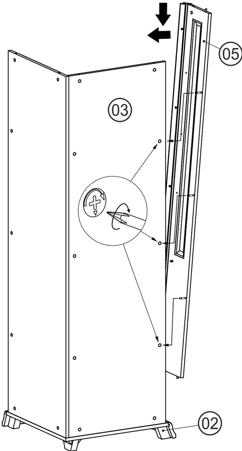
Установить стенку вертикальную правую 06 отверстием в нижней кромке на соединительный винт цоколя 02, при этом шкант стенки вертикальной должен совпасть с соответствующим отверстием цоколя 02.
