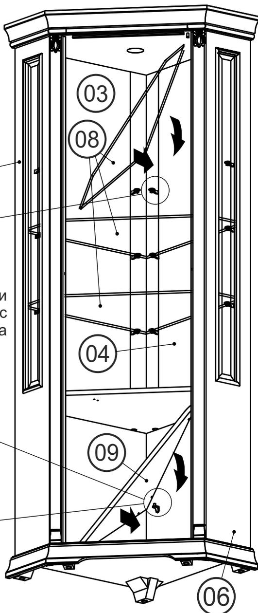
Для этого полки 08 и 09 необходимо повернуть для того, чтобы полки вошли в проем между вертикальных стенок 05 и 06, затем придать полкам горизонтальное положение и установить на полкодержатели.
