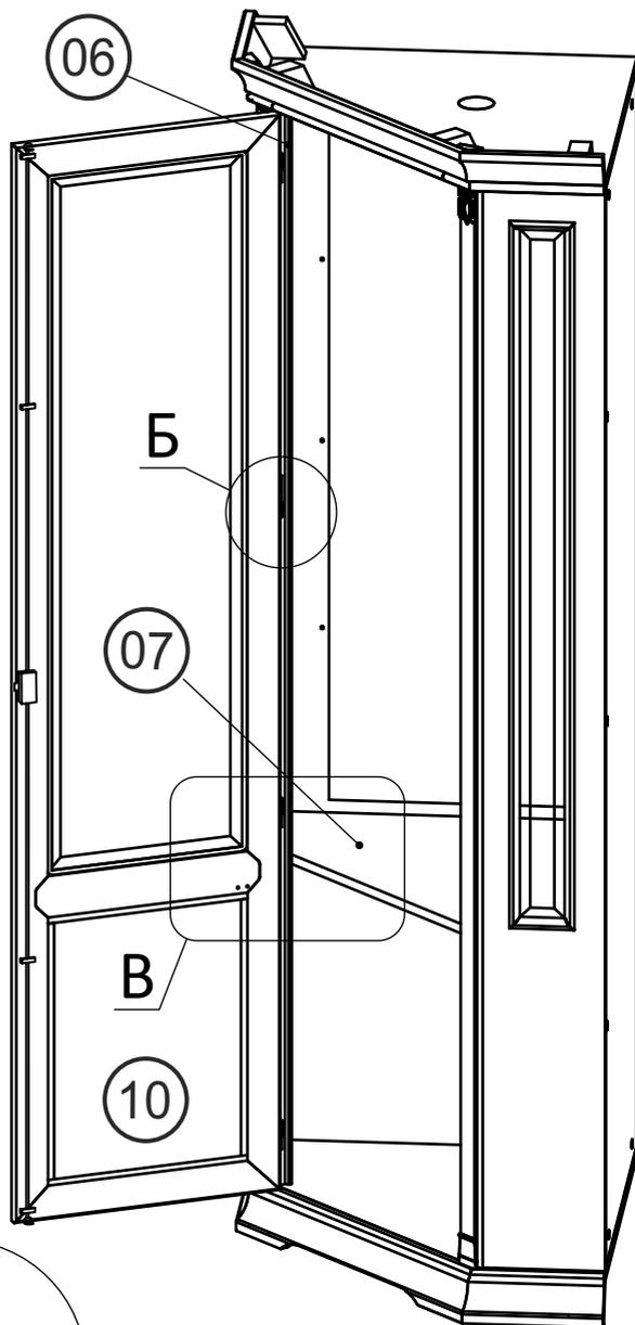
К двери 06 и стенке горизонтальной средней 07 прикрепить ограничитель раскрытия при помощи саморезов 3x13.
