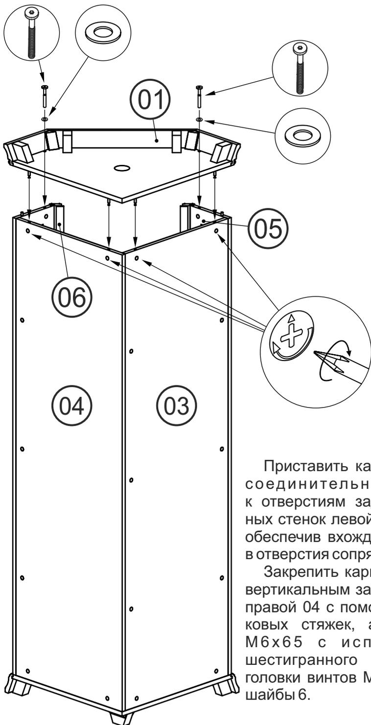
Приставить карниз в сборе 01 соединительными винтами к отверстиям задних вертикальных стенок левой 03 и правой 04, обеспечив вхождение фурнитуры в отверстия сопрягаемых деталей.
